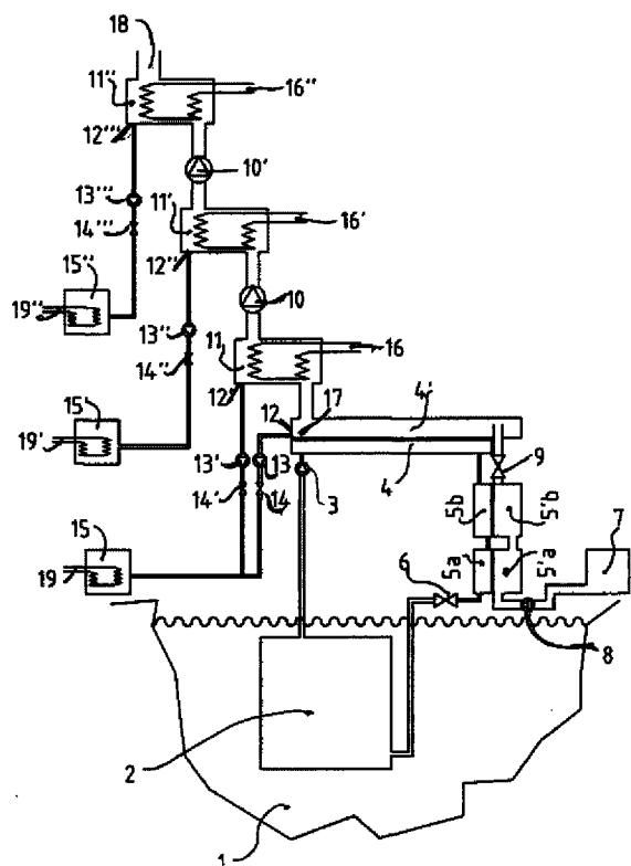
Oppfinnelsen angår metode for fordampning av væsker ved hjelp av varmepumpe, både for produksjon av fordampede væsker til industrielle eller andre tekniske formål, samt fordamping av væsker for destillering.
