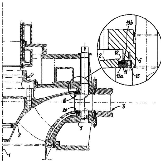
Denne oppfinnelse angår en vannturbin av reaksjonstypen, så som en Francis- eller Kaplanturbin, omfattende en rotor og et omgivende hus, med tetningsanordninger mellom rotoren og huset.
