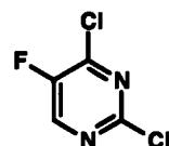
Til 5-fluoruracil (5,0 g, 0,04 mol) ble satt fosforoksyklorid (25 ml, 0,27 mol) og N,N-dietylanilin (6 ml, 0,06 mol) under omrøring ved romtemperatur. Etter å være oppvarmet under tilbakeløp i 100 min ble blandingen konsentrert under redusert trykk. Residuet ble hellet i isvann (100 ml) og ekstrahert med eter. Det organiske laget ble tørket med natriumsulfat og inndampet ved 0°C under redusert trykk, hvilket ga 5,35 g av det ønskede produkt (85%). Sm.p. 37-38°C. HNMR: δ 8,95 (s, 1H).
